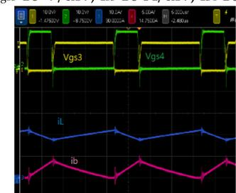
(f) ( $V_{gs3}$  10 V/div;  $i_L$  10 A/div;  $i_b$  5 A/div)
