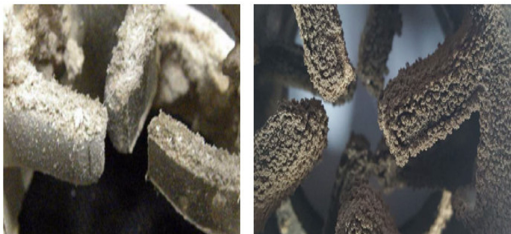
Figure 12. Particles agglomerated on the surface area of the packing technology [60,61]. (Left): Reprint with permission from M. Aleysa, P. Leistner, Verbesserung des Verbrennungs- und Emissionsverhaltens in biomassebetriebenen Einzel-raumfeuerungsanlagen durch den Einsatz spezieller Einbauten; Copyright 2016, Fraunhofer Institute for Building Physics (IBP). (Right): Reprint with permission from M. ALEYSa, Packing technology for emission reduction in wood-burning stoves and biomass boilers, in: Thomas Nussbaumer (Hrsg.), 15. Holzenergie-Symposium: Netzintegration, Vorschriften und Feuerungstechnik., Tagung an der ETH Zürich am 14. September 2018, Verenum Zürich 2018; Copyright 2018, Verenum.
