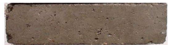
(d) SFRHSEC after freeze–thaw cycles (95% RH)
