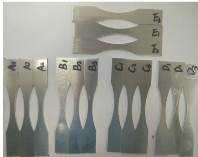
**Figure 3.** Fatigue tensile specimen.
