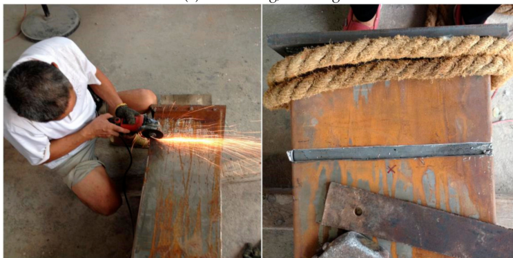
(d) Cutting circular strip
