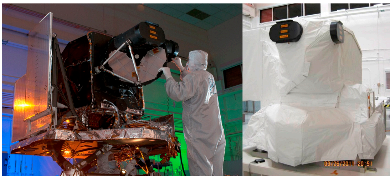
Figure 2. OLI without the thermal blankets ( left ); OLI buttoned up for shipping ( right ).
