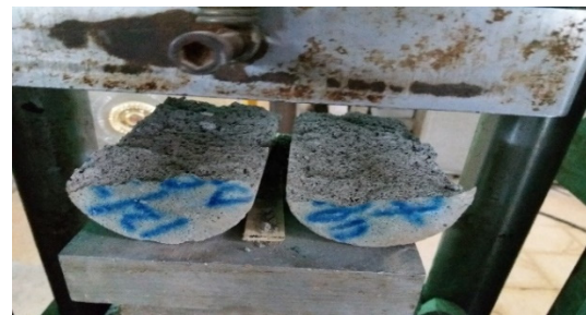
(d) Cross-section of cylinder specimen
