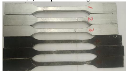
(d) Failure diagram of material specimens
