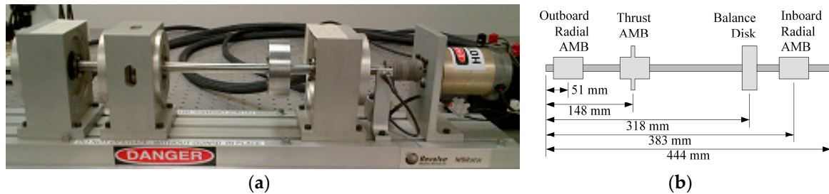
Figure 2. AMB test rig (a) image, and (b) basic dimensions.
