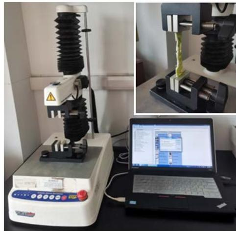
**Figure 11.** Tensile test of broccoli stem.
