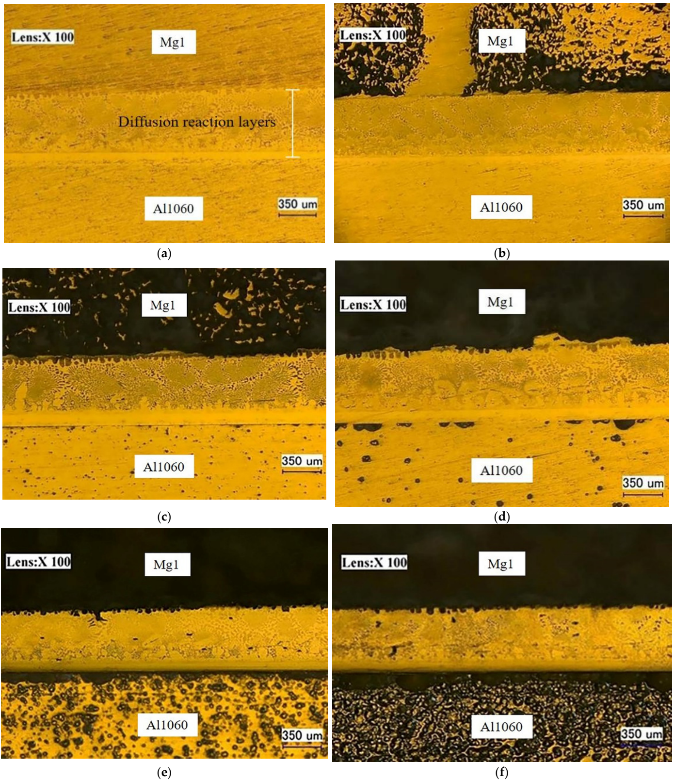
Figure 4. Surface morphology of the substrates and diffusion layers for different immersion times: (a) 0 min, (b) 90 min, (c) 180 min, (d) 270 min, (e) 360 min, and (f) 450 min.
