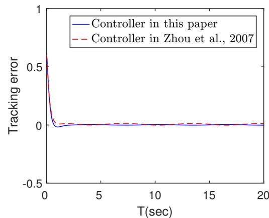
Figure 27. Tracking error [1].
