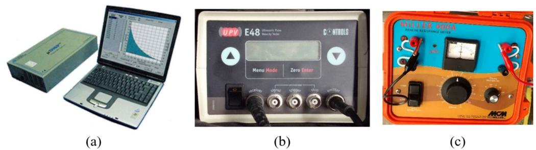
**Figure 8.** (a) Physical Acoustics<sup>®</sup> mDisp<sup>®</sup> AE equipment, (b) Controls<sup>®</sup> E48<sup>®</sup> UPV meter, and (c) M.C. Miller<sup>®</sup> 400A<sup>®</sup> resistance meter.
