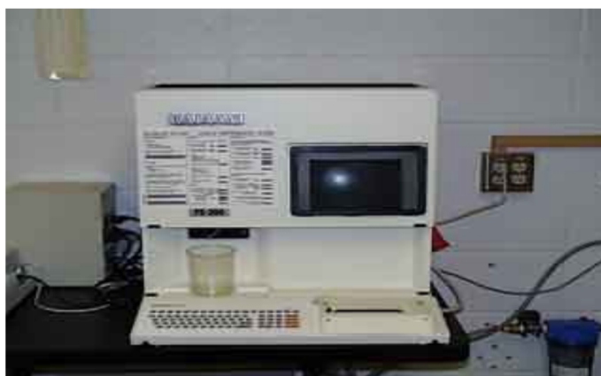
Figure 16. A Kajaani FS-200 Fibre Analyser.
