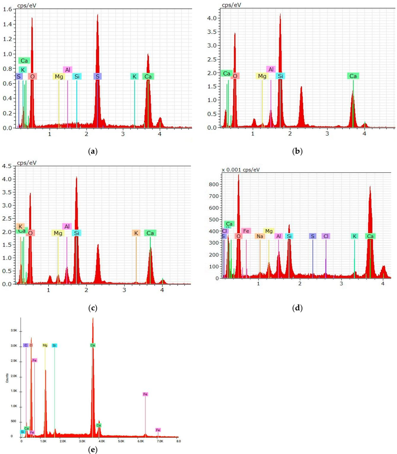
**Figure 10.** EDS analyses: (a) P3P; (b) PE1; (c) Pech; (d) PEE; (e) PPch.
