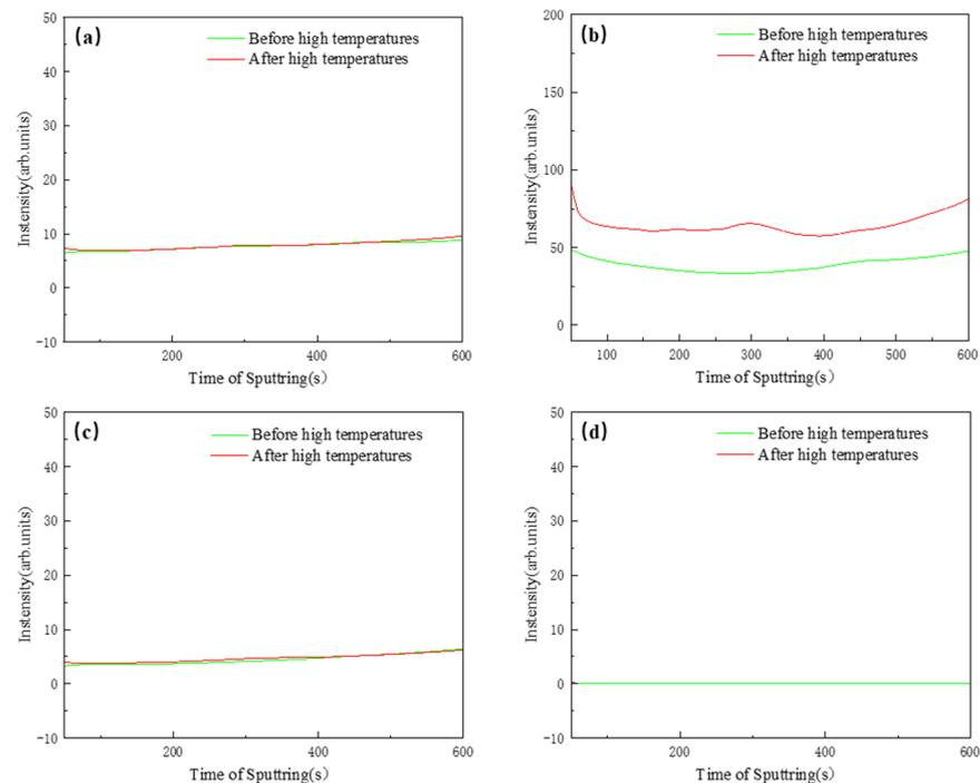
**Figure 6.** Spectral test spectrum of glow power generation: (a) Mg, (b) Li, (c) Al, and (d) Zn.
